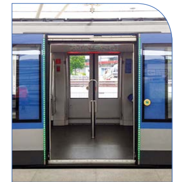
Neu im C2 sind LED-Bänder an den Türen. Wenn sie grün leuchten, ist der Zustieg möglich. Foto unten: Unterwegs gibt es Fahrgastinformationen per Monitor.
