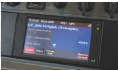
Bordrechnersystem »Copilot« im Fahrzeug
