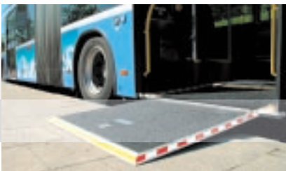
Klapprampen sowie komfortable und barrierefreie Haltestellen mit Leitstreifen für blinde und sehbehinderte Fahrgäste erleichtern das Ein- und Aussteigen.
